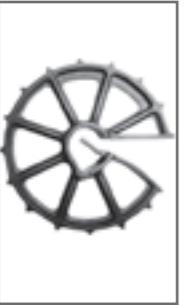
این اسپیسرها مخصوص استفاده در سطوح عمودی مانند دیوار و ستون های بتن باشد که در هر مترمربع از دیوار دو طرفه ۶ عدد و در هر ستون ۳ متری حداقل ۱۶ عدد می باشد.
