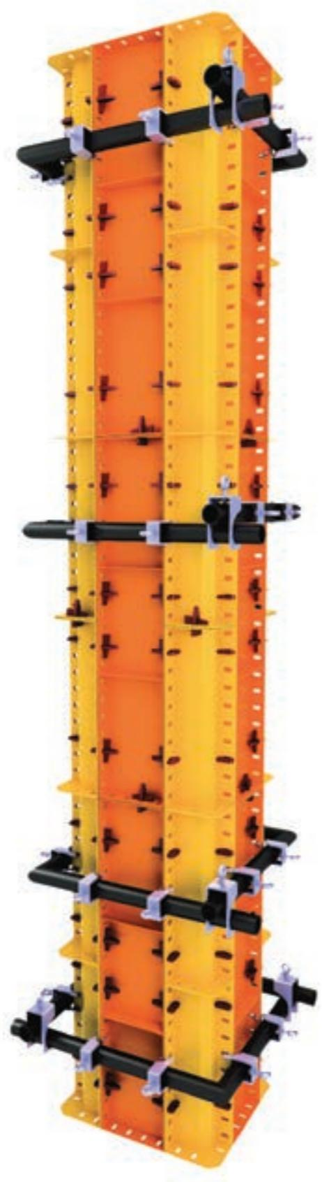
هر قالب ستون مجموعه ای است که شامل: پانل ها، کنج های ببرونی، قید و اتصالات از قبیل پین و گوشه و گیره می باشد. پانل ها در دو نوع خم و جوشی می باشند و اندازه ارتفاع کنج های ببرونی ١٥٠ سانتیمتر و پانل های میانی ١٠٠ یا ٢٠٠ سانتیمتر انتخاب گردد. میانی یکی نباشد و اندازه ارتفاع کنج های ببرونی با پانل های میانی یکی نباشد و اندازه ارتفاع کنج های ببرونی ١٥٠ سانتیمتر و پانل های میانی ١٠٠ یا ٢٠٠ سانتیمتر انتخاب گردد.
