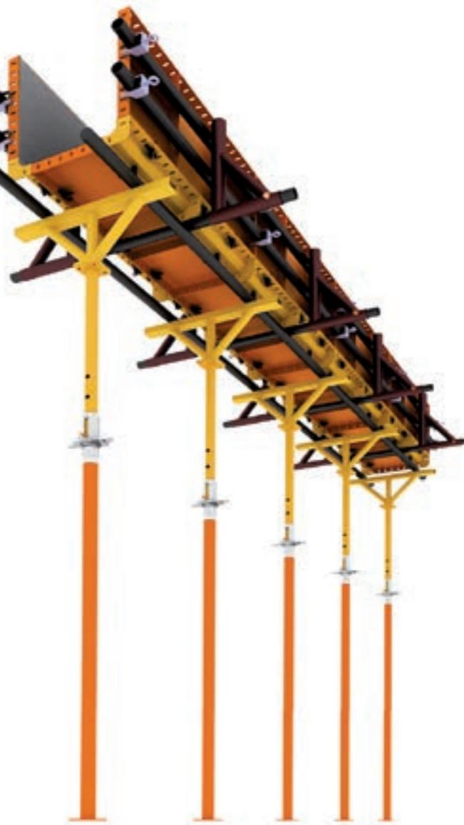
جهت اجرای قالب بندی انواع سقف‌ها اعم از سقف‌های تیرچه بلوك و سقف‌های یکپارچه که شامل دال‌های یک طرفه و دال‌های دو طرفه می‌باشد، می‌توان با استفاده از قالب بندی تیرها به راحتی به سازه موردنظر دست پیدا کرد. هر قالب تیر از دو جزء قالب کف پوتر و قالب آویز که هر دو جزء پانل‌های مدولار می‌باشند تشکیل شده است. ابتدئاً برای اجرای هر قالب نیز علاوه بر قالب کف پوتر و قالب آویز به کنچ‌های بیرونی یا نبشی پانچ شده جهت اتصال دو قالب فوق و همچنین جک‌های سقفی، دستک تیر، اتصالات و ... نیاز داریم.
