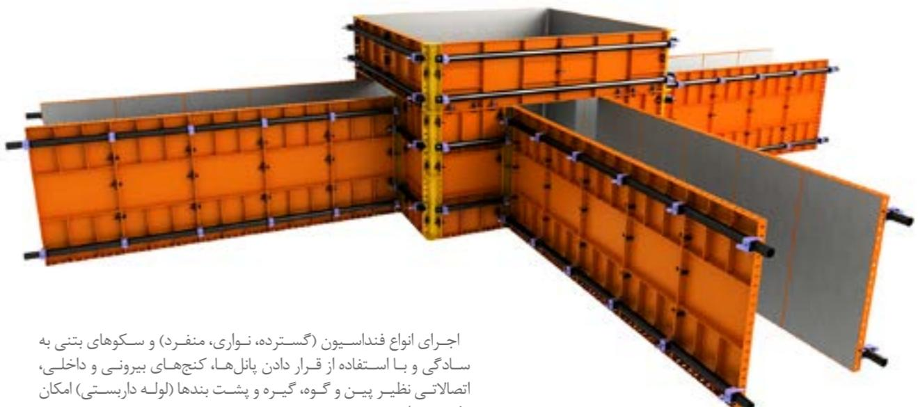
اجرای انواع فندهاسیون (گسترده، نواری، منفرد) و سکوهای بتنی به سادگی و با استفاده از قرار دادن پانل ها، کنج های بیرونی و داخلی، اتصالاتی نظیر پین و گوه، گیره و پشت بندها (لوله داربستی) امکان پذیر می باشد.
